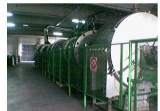
Fig.10 – Forno di riattivazione dei carboni
